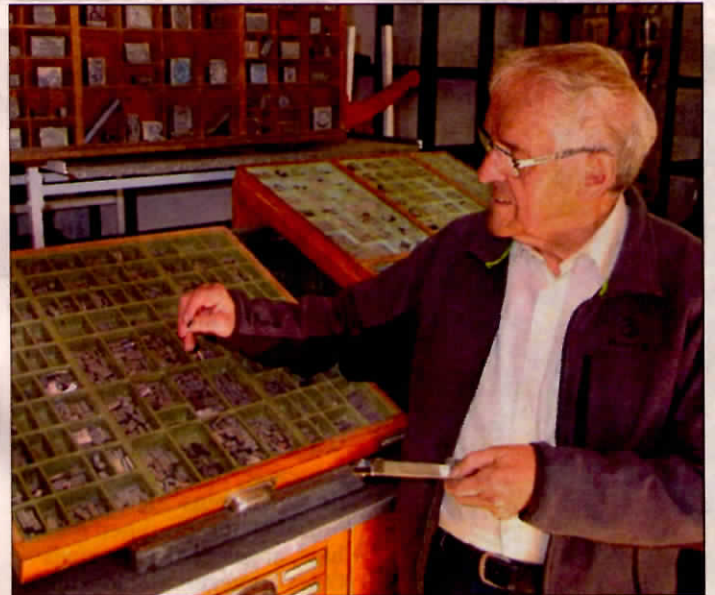
Winkelhaken im Einsatz: Drucker Rudi Homburg (72) in der Gasse der Handsetzerei im Heimatmuseum im Hof Helse. Fotos: Wienecke
